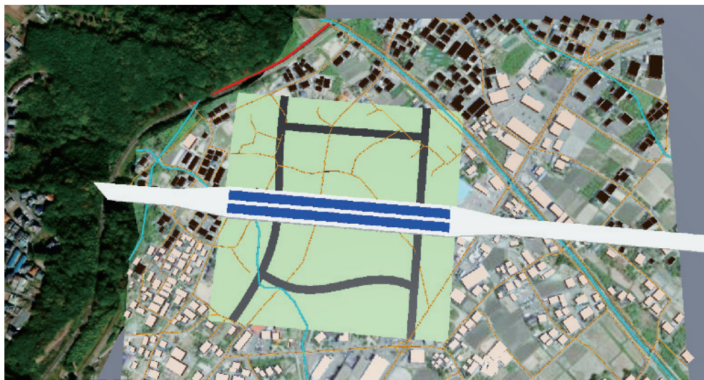
図7 Cesium ion上に中央新幹線の飯田駅の3Dモデルと周辺の建物の3Dモデルを挿入したもの
