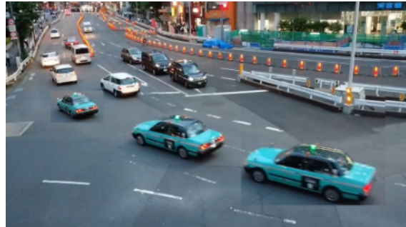
図1(b) 交差点などのカーブ状の道路と直線上の道路での車両形状の変化がある (東京都新宿区西新宿、西新宿交差点歩道橋上より撮影) (同一車両を3つの位置で合成した画像)
