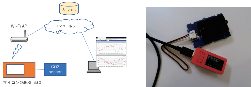
図3 システム構成とセンサ実機の外観
